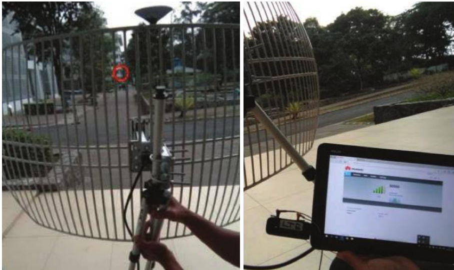
Gambar 2. Skenario Pengujian Menggunakan Modem dan Antena Parabolik.
