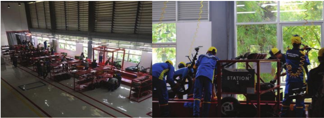
Gambar 3. Assembly Line ITS , mampu menampung produksi 20 unit sepeda motor.
