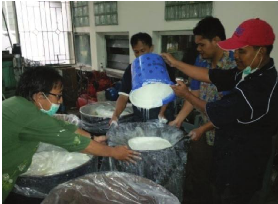
Gambar 1. Proses operasional pengolahan lateks karet alam pravulkanisasi secara manual
