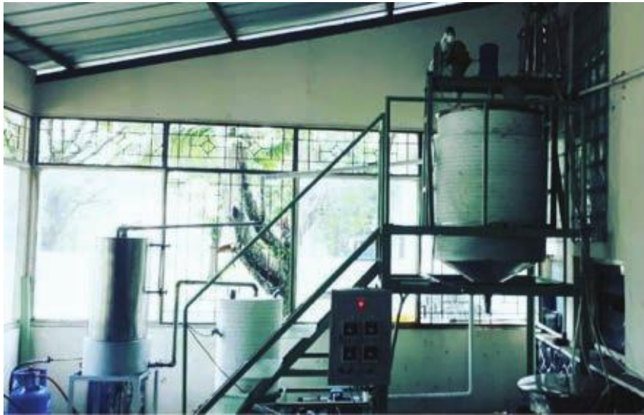
Gambar 2. Proses operasional pengolahan lateks alam pravulkanisasi secara semi otomatis.
