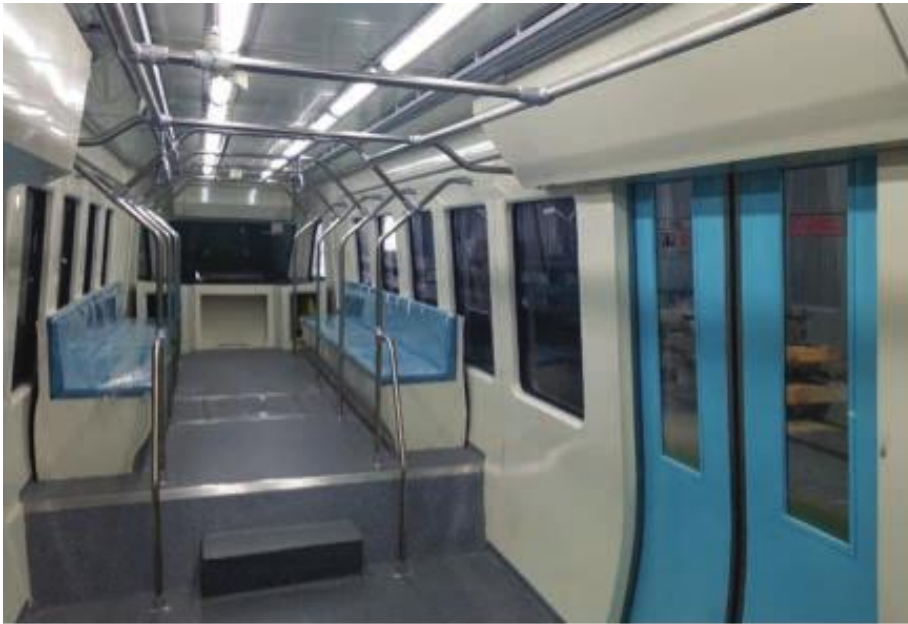
Gambar 2. Foto panel komposit sandwich yang terpasang pada lantai kereta yang telah dilapisi karpet
