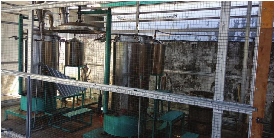
Gambar 2. Instalasi penyulingan minyak atsiri. Ketel inovasi penyulingan telah menyebabkan proses ekstraksi dapat dilakukan lebih cepat, hemat energi dan menghasilkan minyak nilam berkualitas tinggi.
