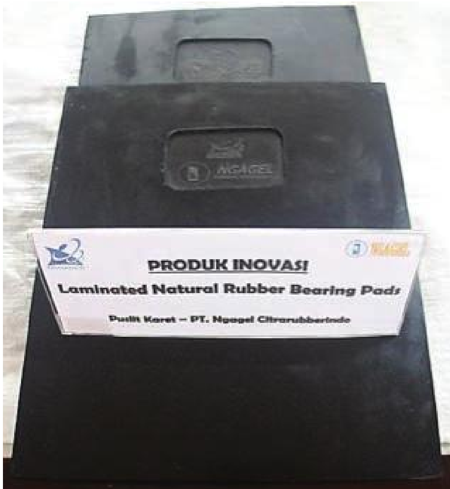
Gambar 1. Produk inovasi karet bantalan jembatan dan jalan layang tipe berlapis dari 100% karet alam
