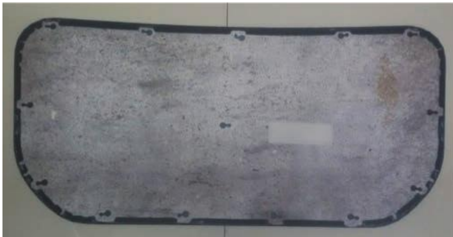
Gambar I. Prototipe door trim mobil berbahan sabut kelapa
