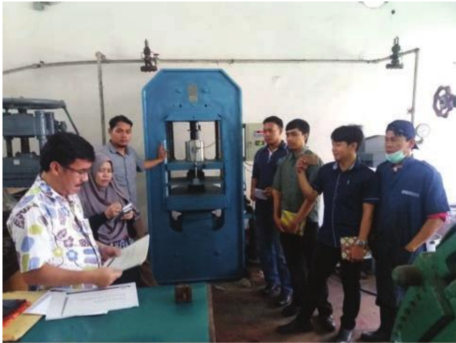
Gambar 2. Proses pengujian sifat dinamik karet bantalan jembatan dan jalan layang
