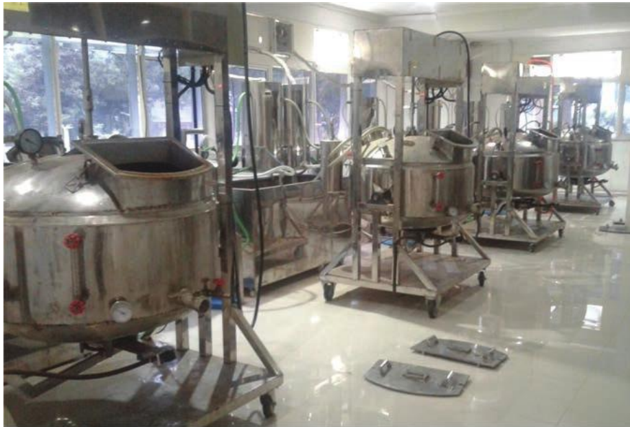
Gambar 2. Mesin evaporator vakum kapasitas tangki 200 liter (4 unit) untuk memproduksi biostimulan Palmarin skala mass production trials di lab produksi PPBBI di Bogor.
