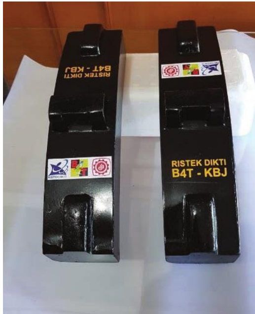
Gambar 3. Produk Hasil Pelatihan Blokrem Komposit Kereta Api oleh Balai Besar Bahan dan Barang Teknik (B4T) kepada SDM Koperasi Batur Jaya
