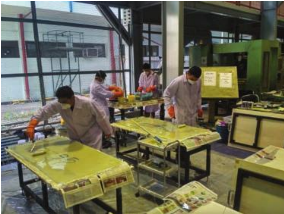
Gambar 1. Proses Trial Produksi Komposit Sandwich Pelapis Lantai LRT di PT INKA
