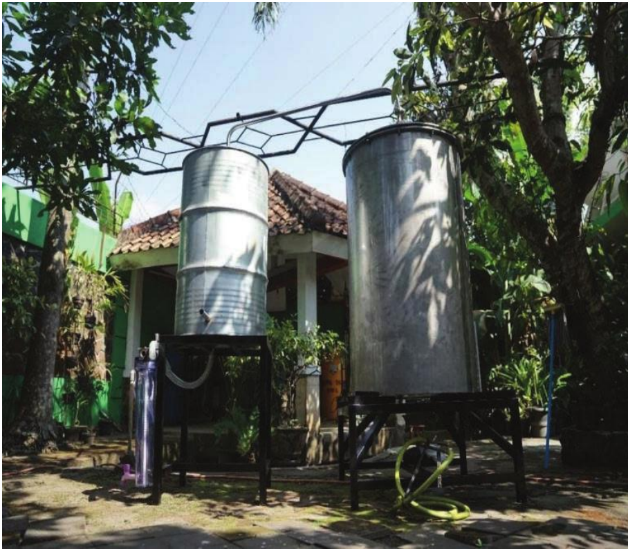
Gambar 2. Teknologi Destiller (Penyulingan minyak Nilam) menggunakan gas produksi Fakultas MIPA UGM.
