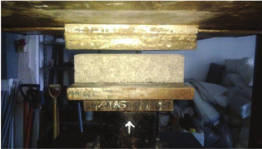
Gambar 3. Alat Uji Tekan Beton, kapasitas 150 ton
