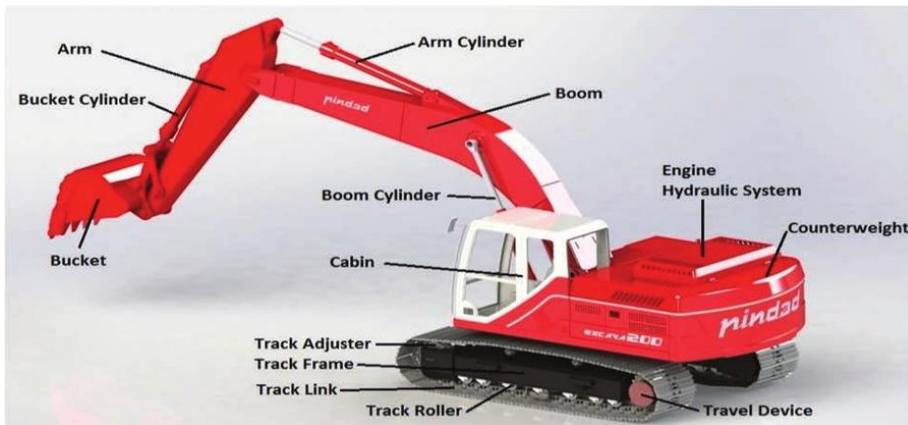
Gambar 2. Bagian-bagian Hydraulic Escavator 20 Ton Merah Putih
