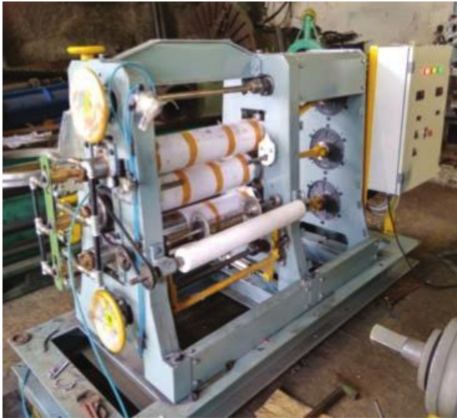
Gambar 3. Mesin calendering lembaran kompon karet
